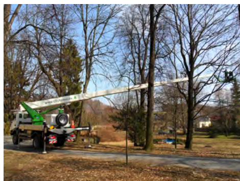
Dank großer seitlicher Reichweite kann der LKW auf dem befestigten Fahrweg bleiben
