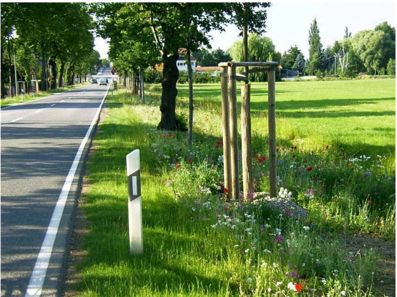
Bankett mit herkömmlichem Straßenbegleitgrün und Grabenbereich mit artenreicher Kräutermischung im Nasssaatverfahren
