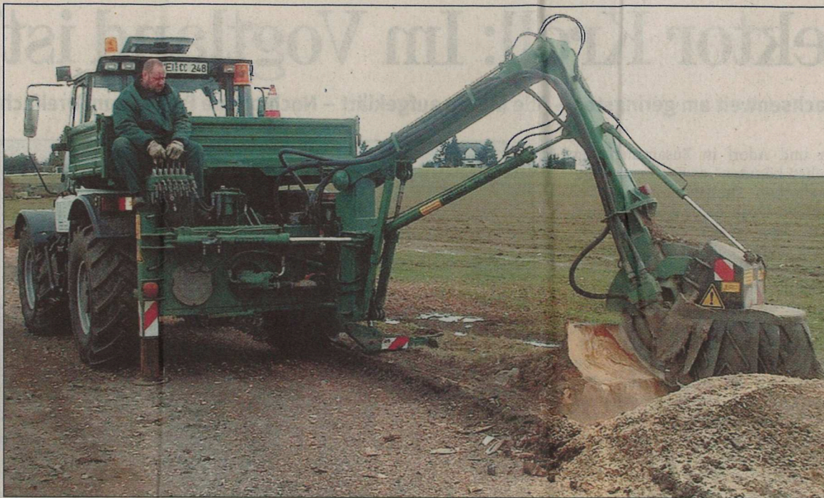
An einem Tag ließ Steffen Braun mit dieser Stubbenfräse elf Baumstümpfe an der Bernsgrüner Straße in Mehltheuer verschwinden. Jetzt sind die Straßenbauarbeiter am Zuge.
