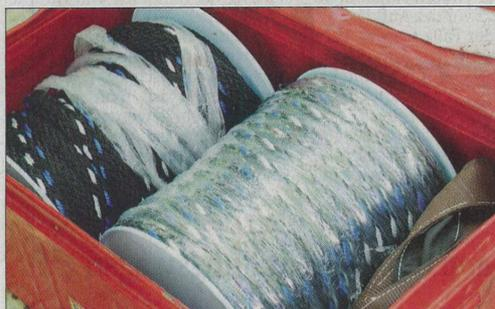
Für die Abspannung werden spezielle Hohl-Täue aus Kunststoff verwendet.
